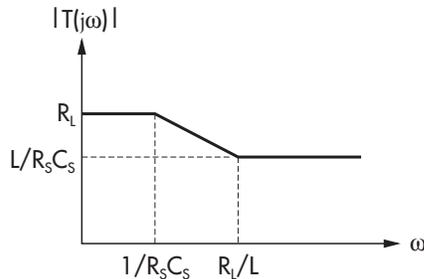
**FIGURE 9 — Sensor Gain**
