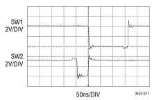
V<sub>IN</sub> = 4.2V V<sub>OUT</sub> = 3.3V AT 500mA
